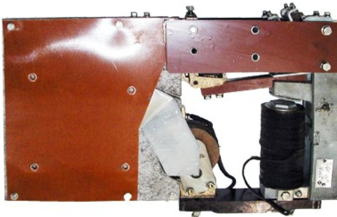
Электромагнитный контактор МК-310Б
